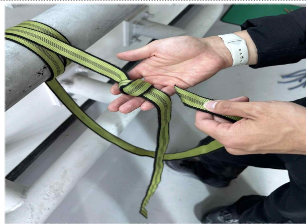
④ 매듭이 없는 끝줄로 웁매듭을 만든 끝줄의 끝에서부터 따라가며 웁매듭의 매듭 부위로 접근한다.
