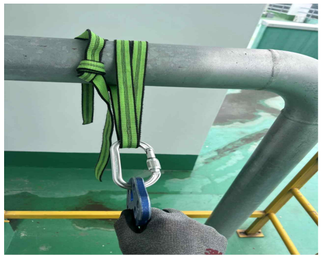
④ 두 줄을 당겨 카라비너 및 확보판에 연결한 후 매듭 부분은 전면에 위치하도록 하며, 하중이 가해지지 않도록 한다.
