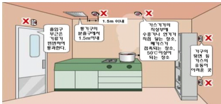
[ 그림 1-86 ] 가스누설경보기 검지기 설치장소
