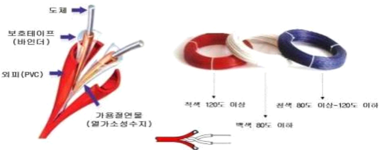
[ 그림 1-19 ] 정온식감지선형감지기의 형태 및 표시
