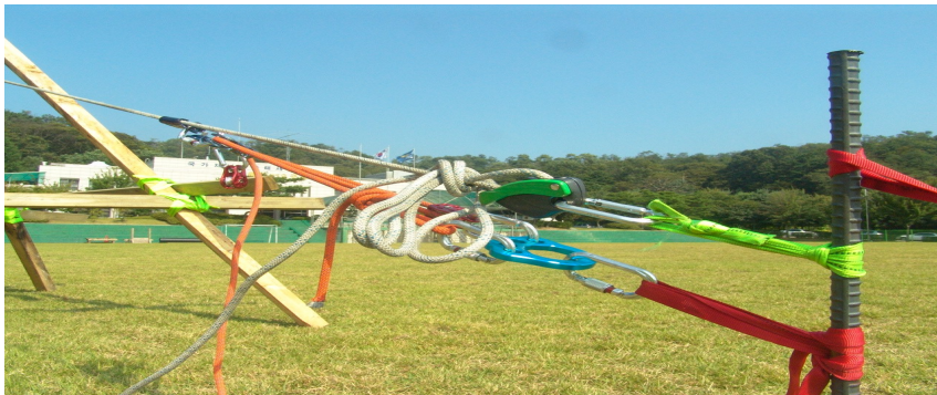
[ 그림 4-67 ] 인공말뚝·삼각대·당김장치 운용방법
