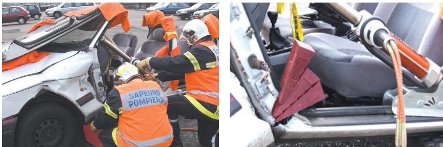
[그림 4-190] 계기반 전방이동 방법으로 공간을 확보
