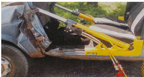
[ 그림 4-203 ] 차량 프레임 밀어내는 법
