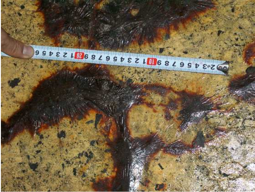
[ 그림 4-147 ] 연소촉진제 살포에 의한 불연속적인 바닥의 연소상황
