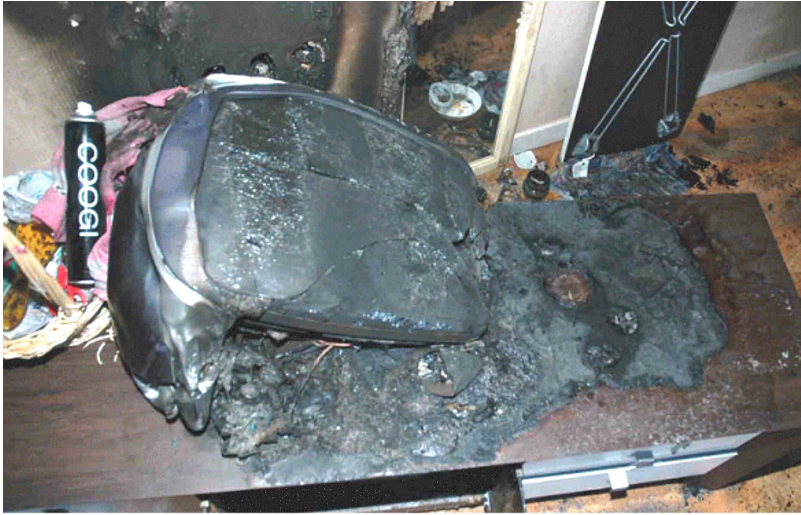
[ 그림 4-67 ] TV 케이스1 (소손되어 우측으로 넘어진 것으로 보아 연소방향은 우→좌)
