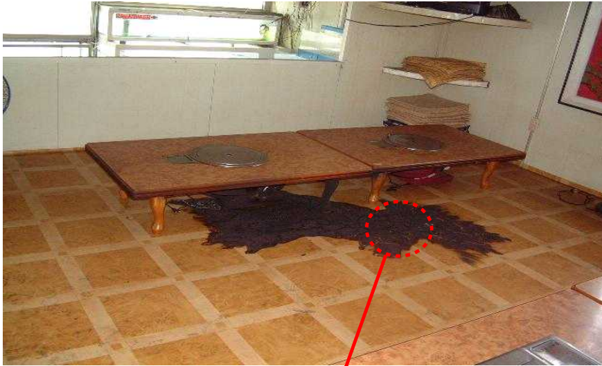
[ 그림 4-144 ] 연소촉진제 살포에 의한 바닥의 연소상황
