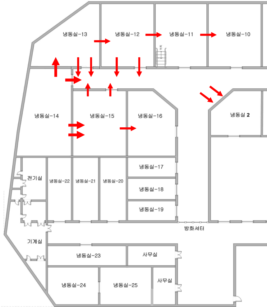
[ 그림 4-82 ] 13호실 주위의 벽체 파손 방향 (➡ : 넘어지거나 밀려난 방향)
