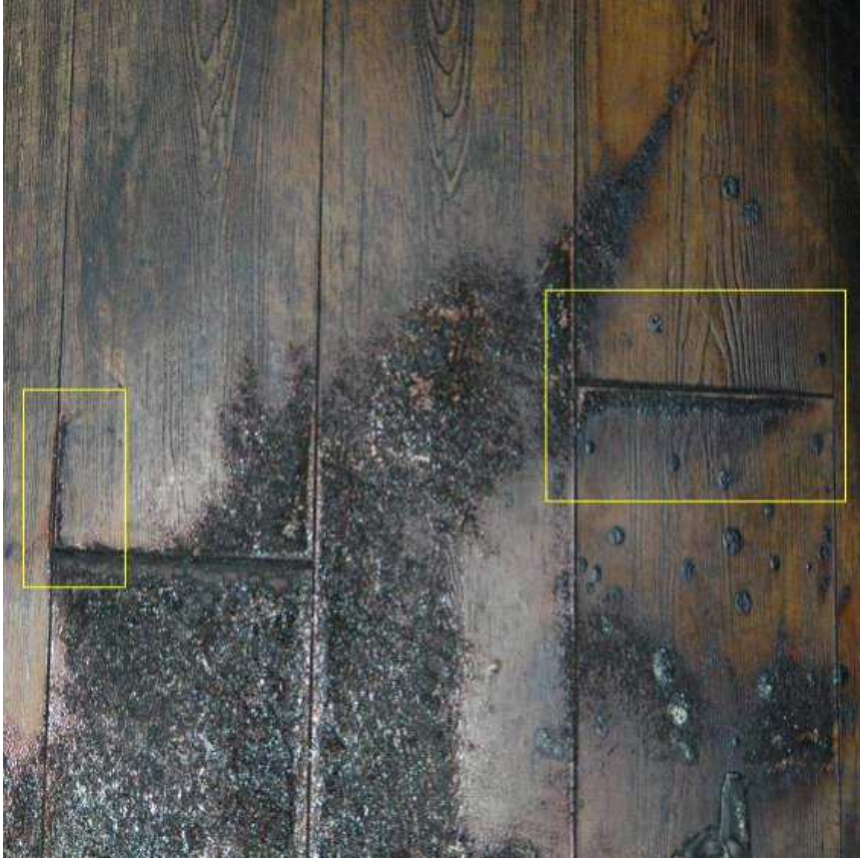
[ 그림 4-151 ] 유류에 의한 틈새의 연소 패턴 9)
