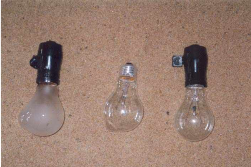
[ 그림 4-62 ] 전구의 수열에 의한 변형1 (연소방향은 좌→우)
