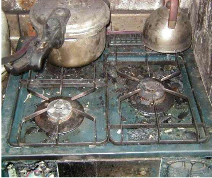
변색8 [ 그림 4-32 ] 가스렌지 화구 (발화부위는 백색으로 변한 부분)
