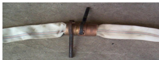
호스 개폐기(Spanner)를 이용한 소방호스 연결모습
