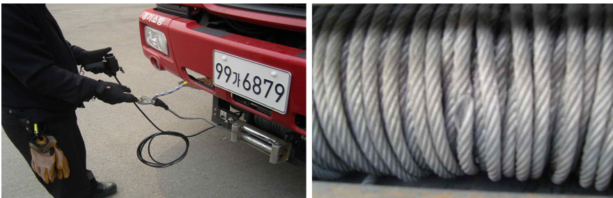
윈치 작동 상태 및 와이어 감김, 손상 여부 확인한다.
