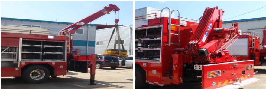
크레인 작동 상태 및 와이어 상태 및 작동상태 그리스 도포 등을 확인한다.
