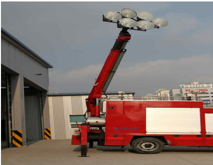
아우트리거 작동 및 손상 여부 및 조명탑(크레인) 작동, 이음 발생 여부
