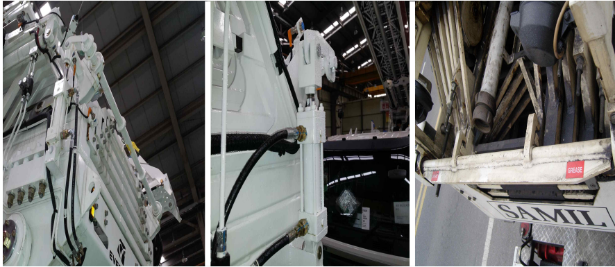
유압의 누유 및 손상여부 확인, 신장 시 해제되고 수축/안착 시 잠기는지 확인
