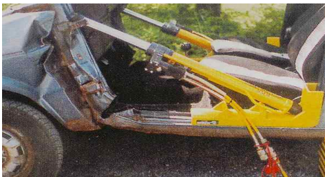
[ 그림 4-203 ] 차량 프레임 밀어내는 법
