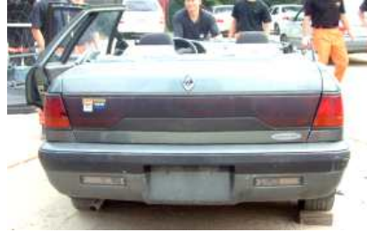
[ 그림 4-201 ] 지붕을 뒤로 접어 올린다. [ 그림 4-202 ] 지붕을 제거한 차량
