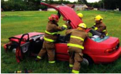
[ 그림 4-201 ] 지붕을 뒤로 접어 올린다. [ 그림 4-202 ] 지붕을 제거한 차량
