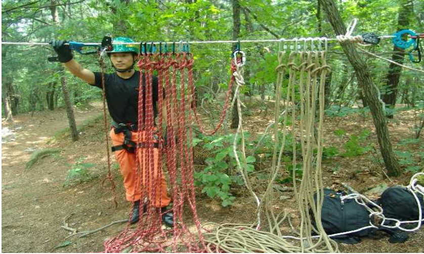
[ 그림 4-138 ] 1·2견인로프 설치
