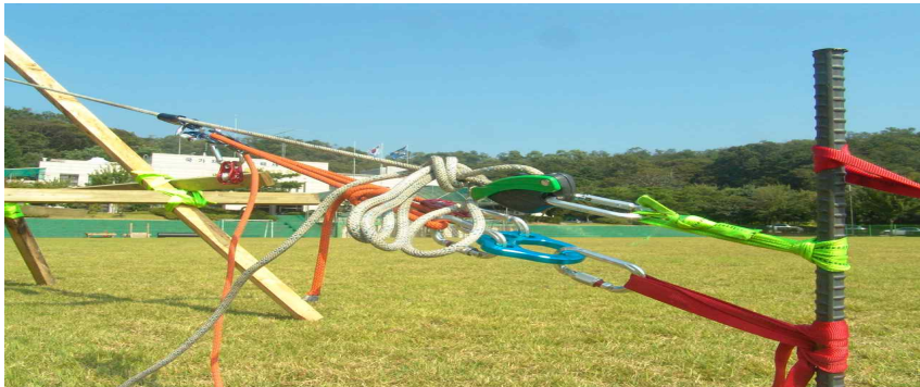
[ 그림 4-67 ] 인공말뚝·삼각대·당김장치 운용방법
