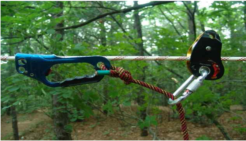
[ 그림 4-137 ] 진입장치 설치
