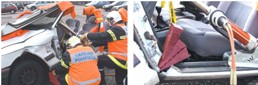
[ 그림 4-190 ] 계기반 전방이동 방법으로 공간을 확보
