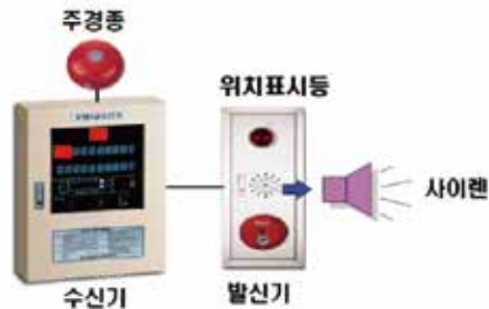
비상경보설비 중 자동식사이렌설비의 구성도(일반적인 건물 설치 형태)
