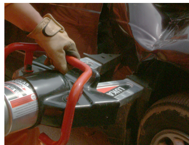
[그림 4-195] 웬더를 전개기로 압축한다. [그림 4-196] 전개기로 틈을 벌린다.
