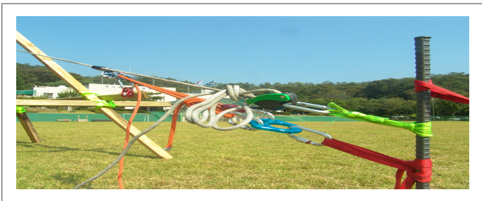
[그림 4-67] 인공말뚝·삼각대·당김장치 운용방법
