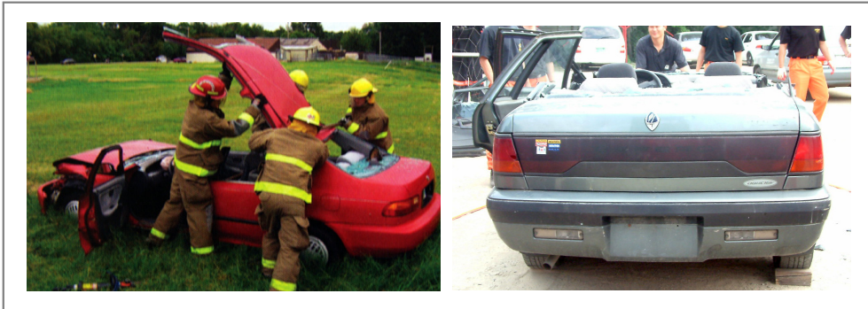
[그림 4-201] 지붕을 뒤로 접어 올린다. [그림 4-202] 지붕을 제거한 차량
