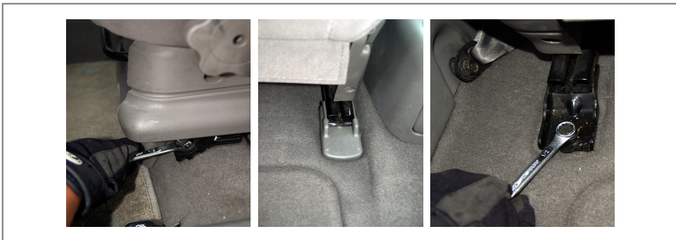
[그림 4-192] 운전석 의자를 분리하는 방법
