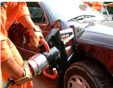
[그림 4-195] 웬더를 전개기로 압축한다. [그림 4-196] 전개기로 틈을 벌린다.
