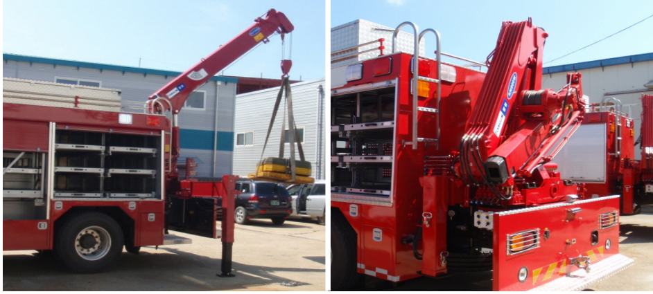
크레인 작동 상태 및 와이어 상태 및 작동상태 그리스 도포 등을 확인한다.
