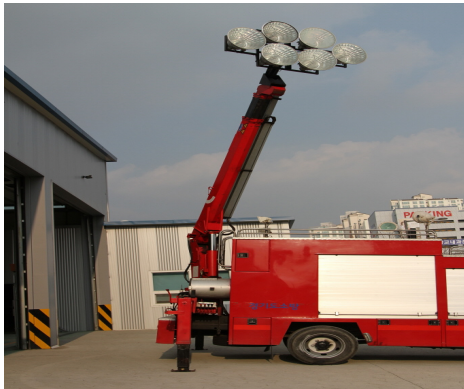
아우트리거 작동 및 손상 여부 및 조명탑(크레인) 작동, 이음 발생 여부
