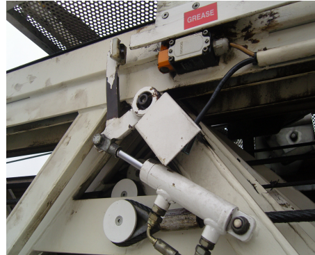
유압의 누유 및 손상여부 확인, 승강 시 해제되고 하강 완료 시 잠김 여부 확인
