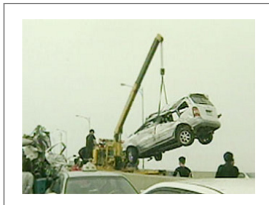
[그림 5-13] 크레인을 이용한 차량 인양
