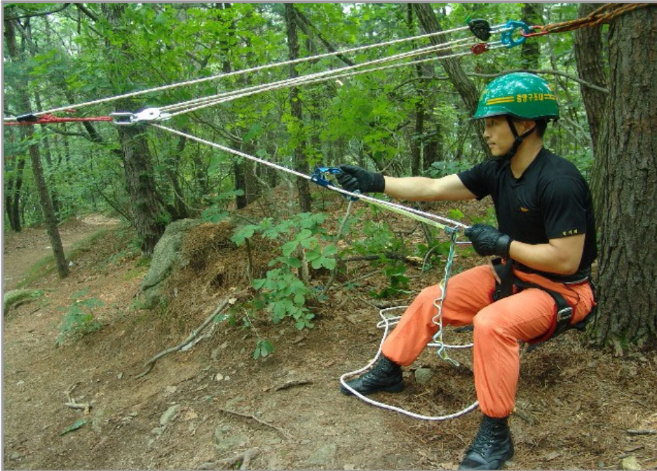
[그림 4-137] 로프당김 (등강기와 띠고리를 이용한 당김)
