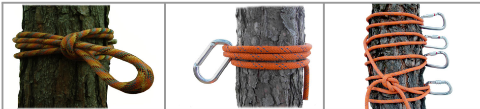
[그림 4-109] 확보물과 확보로프 설치
