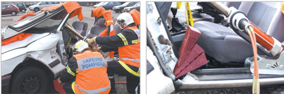
[그림 4-192] 계기반 전방이동 방법으로 공간을 확보
