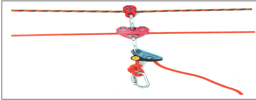
[그림 4-128] 그리그리를 이용한 조절장치
