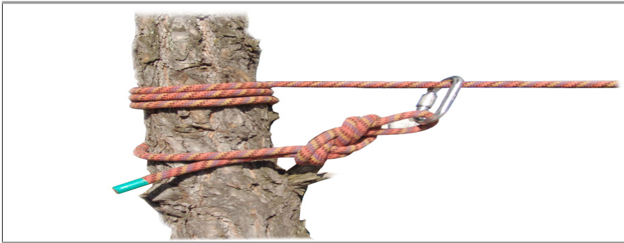
[그림 4-106] 설명서의 주요 그림 - 감기법
