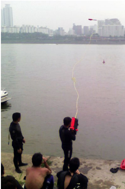
[그림 4-218] 구조로켓의 발사 모습. 로켓이 물에 닿으면 자동으로 구명환이 펼쳐진다.
