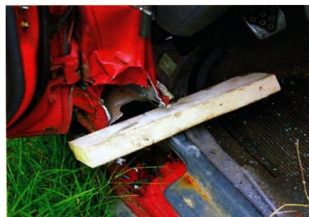
[그림 4-205] 유압램으로 프레임을 밀어내고 모서리에는 나무토막을 끼워둔다.
