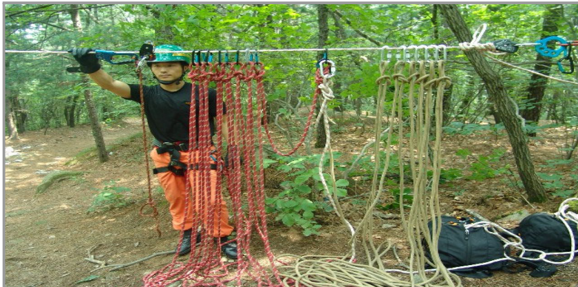
[그림 4-139] 1·2견인로프 설치
