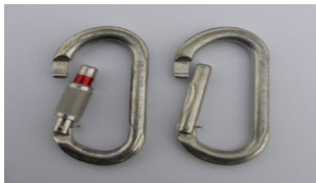
[그림 3-56] 결빙시 강제 개방으로 파손된 개폐구
