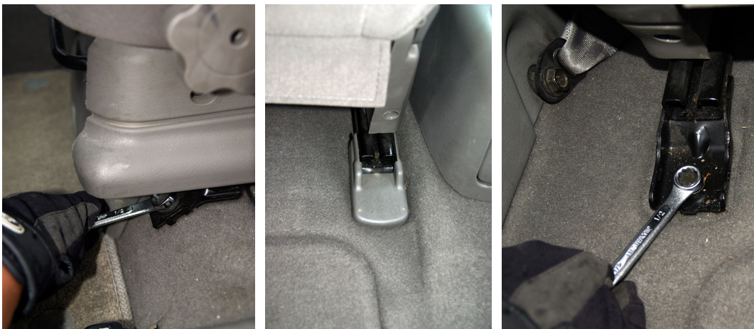
[그림 4-194] 운전석 의자를 분리하는 방법
