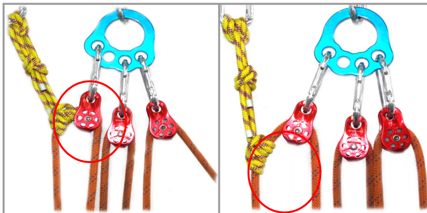
[그림 4-151] 슬링을 이용한 고정방법
