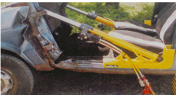
[그림 4-205] 유압램으로 프레임을 밀어내고 모서리에는 나무토막을 끼워둔다.
