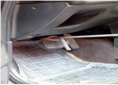
[그림 4-189] 페달에 로프를 묶고 반대쪽을 창틀에 묶어 바깥쪽으로 젖힌다.
