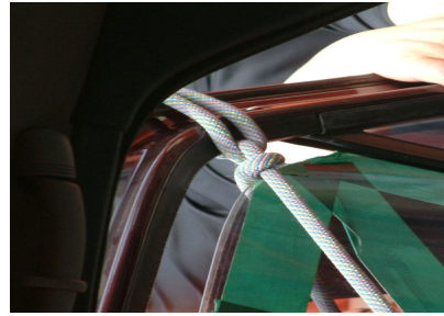
[그림 4-189] 페달에 로프를 묶고 반대쪽을 창틀에 묶어 바깥쪽으로 젖힌다.
