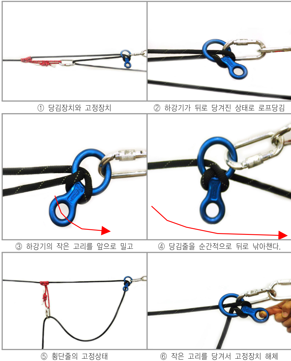
[그림 4-114] 8자하강기를 활용한 고정장치 활용방법
