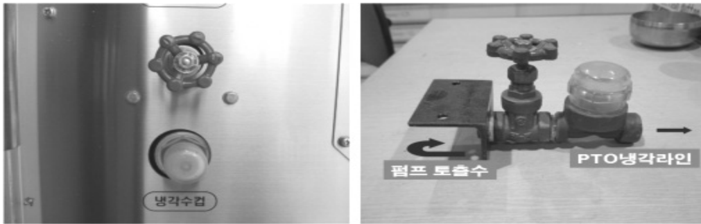
(그림52 - A지점, 냉각수 밸브 및 스트레이너)
