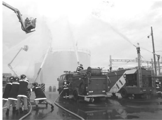
그림 5.7_무인대량방수장비는 탱크를 냉각시키는 데 사용한다.
