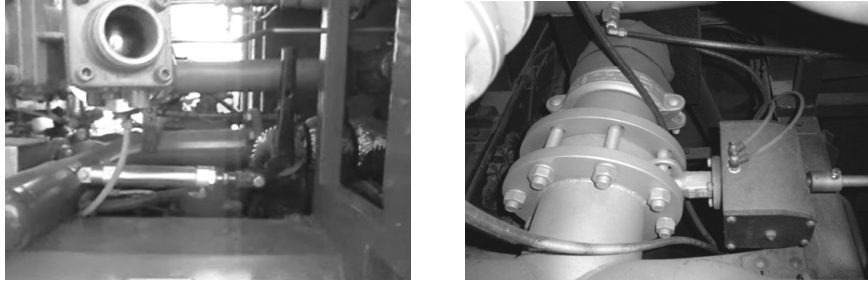
(그림11 - 복동식실린더 및 밸브실린더 일체형 액추에이터)
