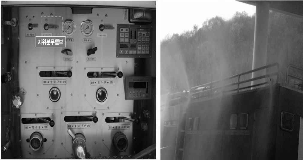
(그림55 - 자위분무밸브 및 분무장면)
