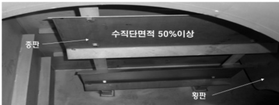
(그림56 - 물탱크 내부 방파판)
