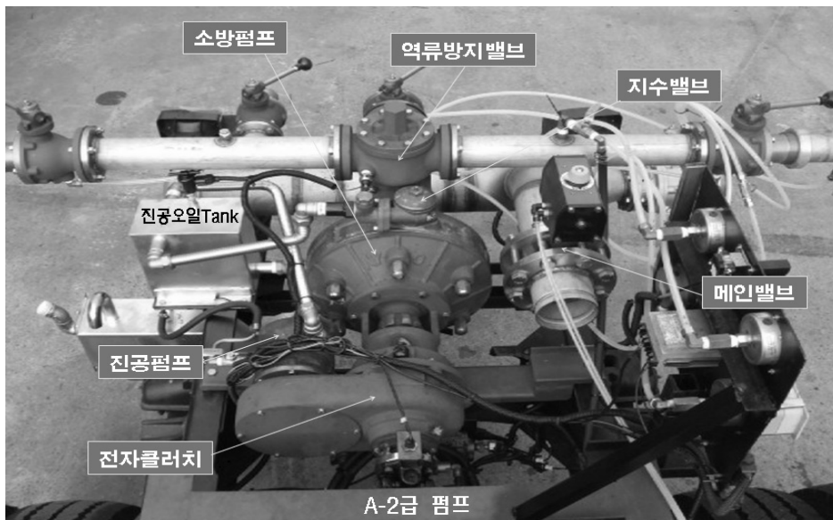
(그림12 - 소방자동차 배관계통도 및 펌프주변 장치)
