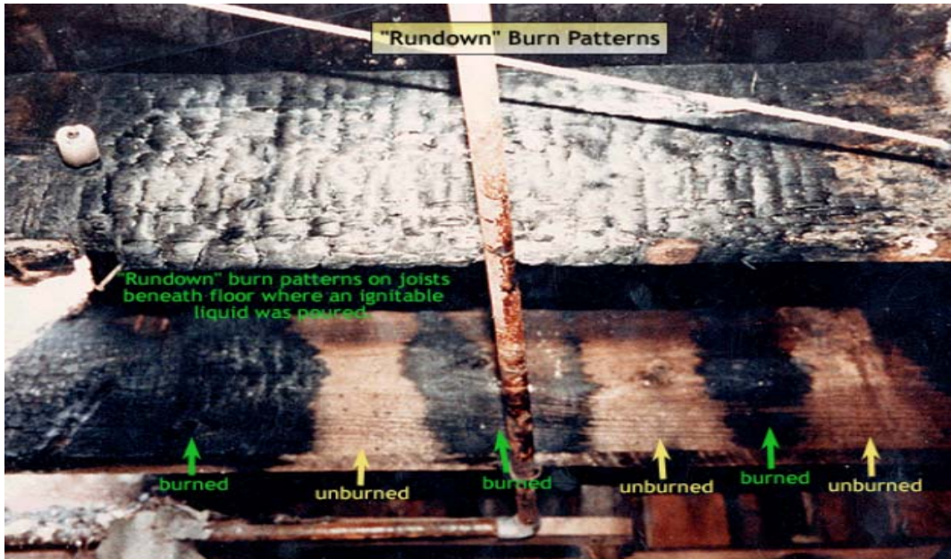
〈사진46〉 액체의 흘러내림(Run down) 패턴
