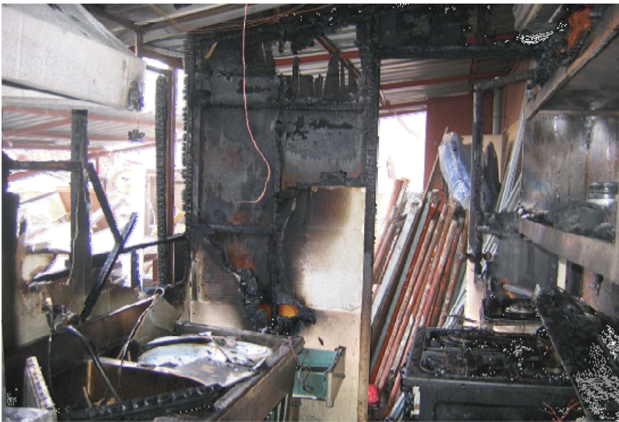
〈사진31〉 전자레인지로 중심으로 올라간 화재 패턴
