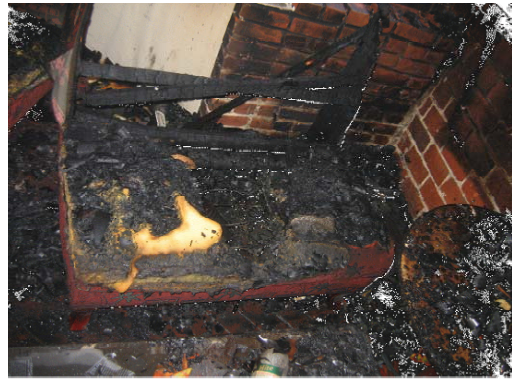
〈사진29〉 무염연소 후 화재로 진전되어 나타난 V-shaped Pattern
