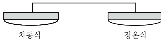
[그림 26] 열 복합형 감지기의 구성
