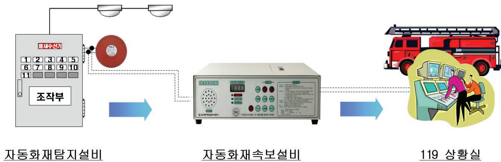
(그림 2) 자동화재속보설비 작동 구성도
