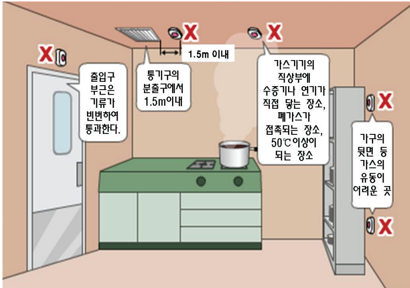
(그림 1) 가스누설경보기 검지기 설치장소
