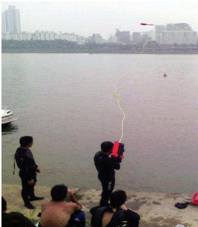
(그림 5-53) 구조로켓의 발사 모습. 로켓이 물에 닿으면 자동으로 구명환이 펼쳐진다.
