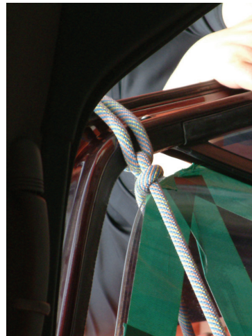
(그림 5-30) 페달에 로프를 묶고 반대쪽 끝을 창틀에 묶은 다음 차문을 바깥쪽으로 젖힌다.
