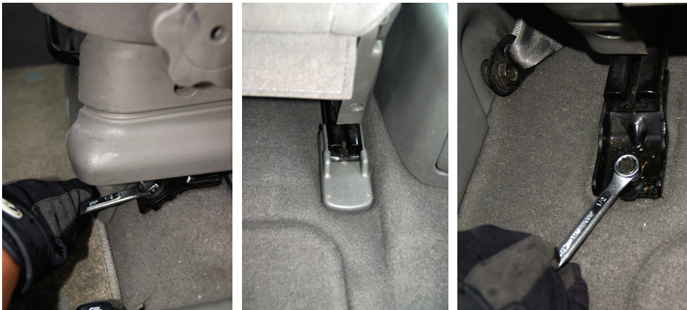
(그림 5-34) 운전석 의자를 분리하는 방법
