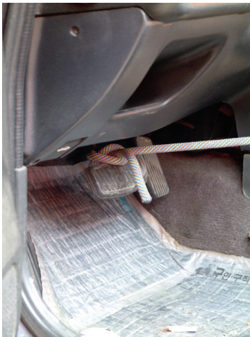
(그림 5-30) 페달에 로프를 묶고 반대쪽 끝을 창틀에 묶은 다음 차문을 바깥쪽으로 젖힌다.
