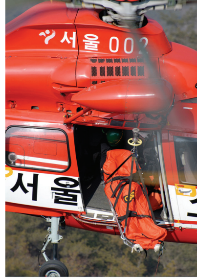
[그림 5-96] 들것이 흔들리지 않도록 지상에서 로프로 잡아 주어야 한다. 들것과 호이스트를 연결하는 로프는 가급적 짧게 하는 것이 좋다.
