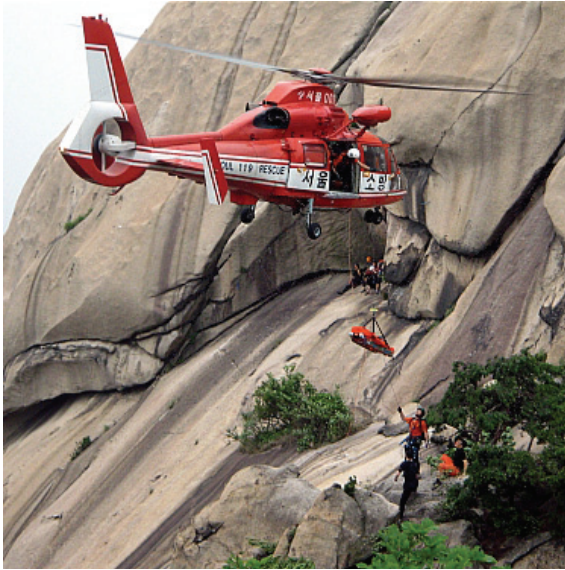
[그림 5-96] 들것이 흔들리지 않도록 지상에서 로프로 잡아 주어야 한다. 들것과 호이스트를 연결하는 로프는 가급적 짧게 하는 것이 좋다.
