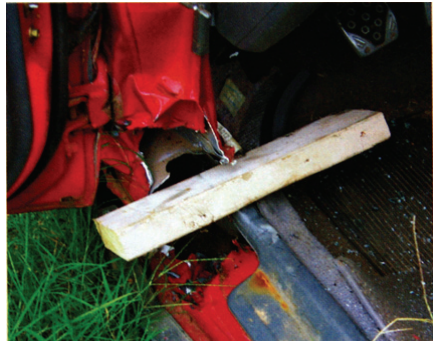
[그림 5-45] 유압램으로 프레임을 밀어내고 모서리에는 나무토막을 끼워둔다.
