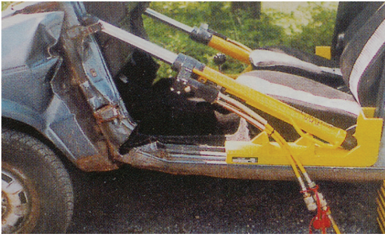
[그림 5-45] 유압램으로 프레임을 밀어내고 모서리에는 나무토막을 끼워둔다.
