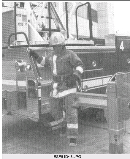
(그림 5.32) 만약 감전된 소방차에서 빠져 나올 필요가 있을 때는 소방대원이 소방차와 지면에 동시에 닿지 않도록 소방차로부터 뛰어나와야 한다.
