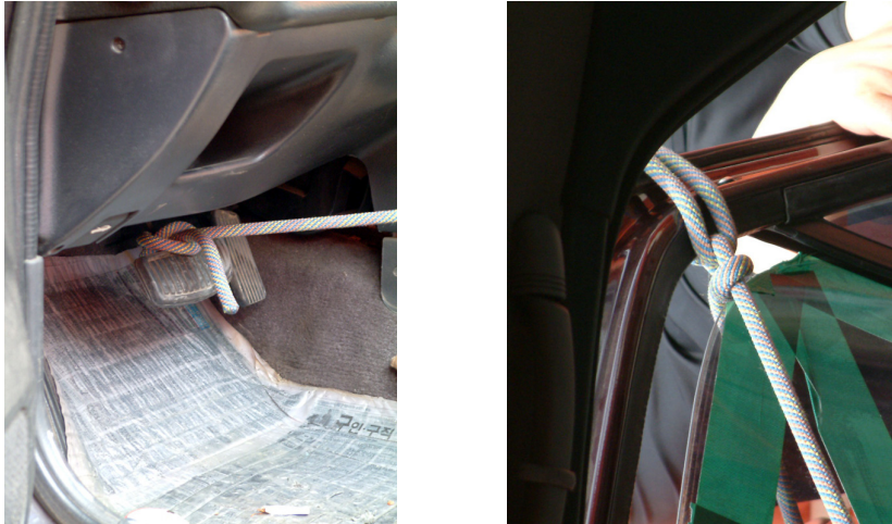
[그림 5-30] 페달에 로프를 묶고 반대쪽 끝은 창틀에 묶은 다음 문을 바깥쪽으로 젖힌다.
