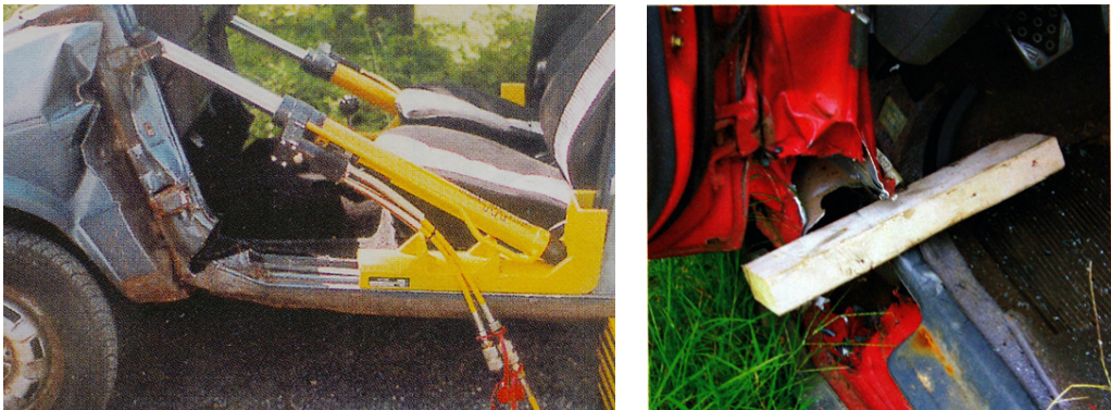
[그림 5-45] 유압램으로 프레임을 밀어내고 모서리에는 나무토막을 끼워둔다.
