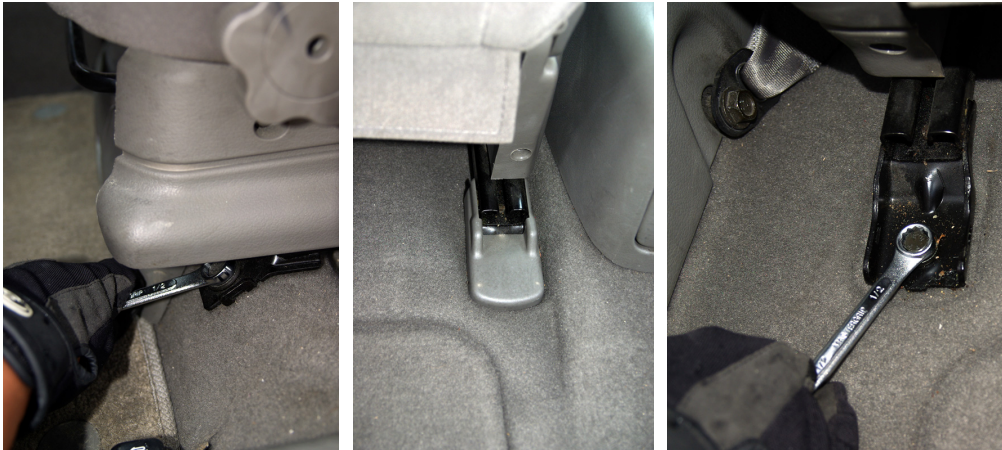
[그림 5-34] 운전석 의자를 분리하는 방법
