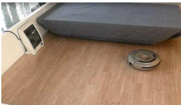
ON/OFF스위치가 하부에 위치한 전기스토브가 방에 설치되어 있을때를 가정하여 로봇청소기를 동작시켜 전원스위치를 작동하도록 재현해 보았다. 전기스토브의 ON스위치의 바닥으로부터 5cm 상부에 위치되어 있으며, 로봇청소기 범퍼가 물체에 닿는고무부위의 높이는 4.4~5.4cm로 정확하게 전기스토브 ON스위치를 누를수 있게 되어 있다.
